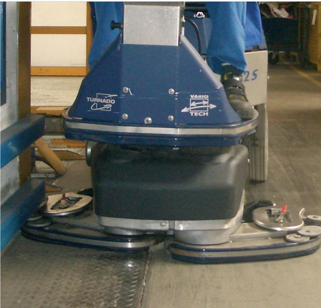
Selbst unter Regalen sowie Hand- und Fussläufen kann mit der FS 112 problemlos gereinigt werden.
